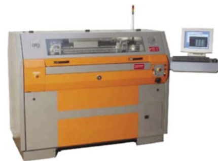
Рис. 1. Установка электрического контроля с подвижными измерительными зондами
